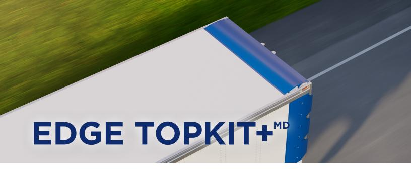
Une solution innovante qui réduit la traînée et ne nécessite aucune interaction avec le conducteur pour optimiser l'aérodynamisme de l'arrière de la remorque.
